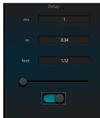
**Кнопка активации:** Активируйте назначенный модуль задержки в модулях и вставьте его в тракт аудиосигнала, чтобы увеличить фиксированное время задержки сигналов.
