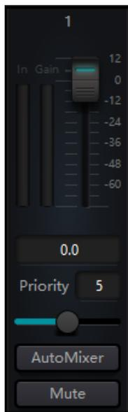
**Auto Mix:** На каждом канале есть кнопка включения / выключения автоматического микширования, которая должна быть включена, чтобы каналы могли участвовать в автоматическом микшировании. Он также может быть закрыт, и тогда канал не будет участвовать в automix.
