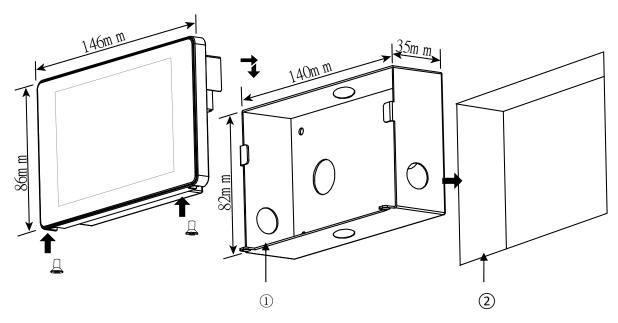
(Примечание: отверстие распределительной коробки 1 должно быть плоским или слегка выступать из стены 2).
